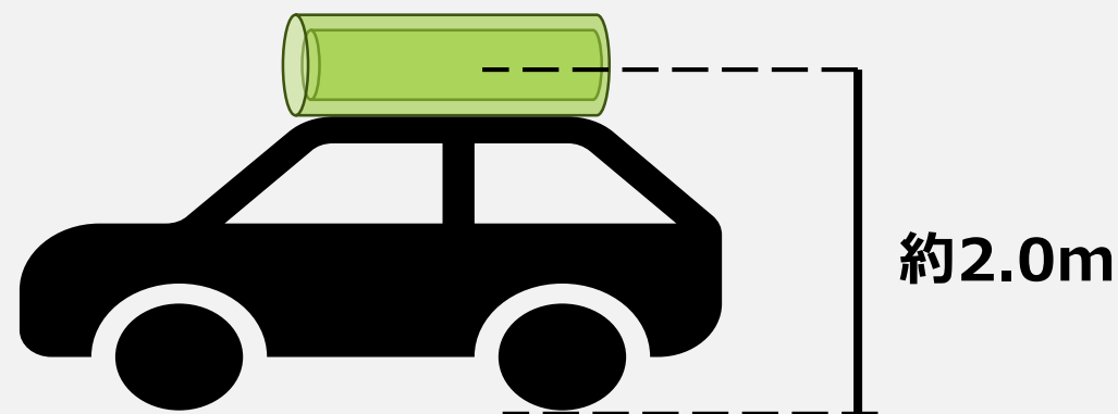
図. 自動車に設置した気温の観測測器の模式図
