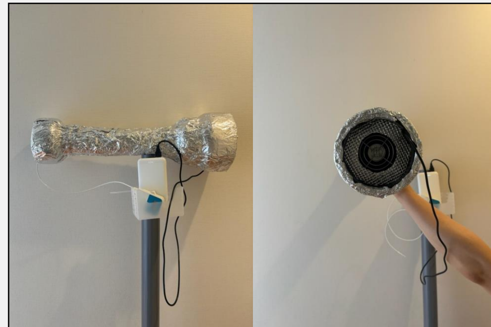
図. 自作の強制通風筒
