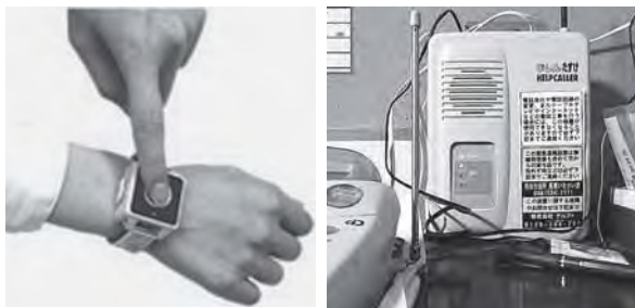
緊急時通報システムの発信機(左)と受信機(右) 発信機のボタンを押すと受信機が受信し、電話回線を通じて消防本部へ通報される
