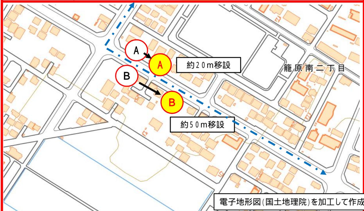
【移設理由】交差点への右折レーン設置に伴い、車線境界線を延伸するため。Bの移設に伴い、Aも位置を調整。令和7年3月移設済
