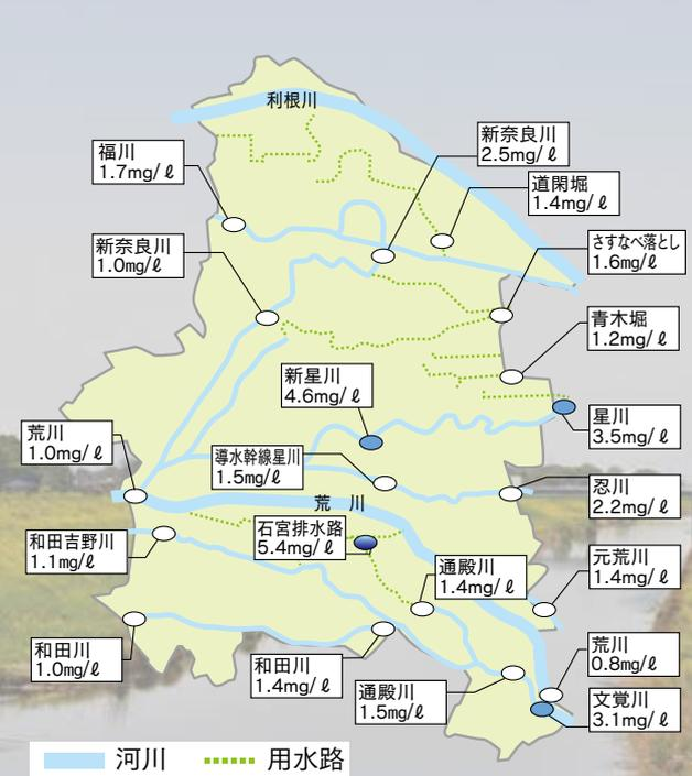
BODとは、川の汚れ(有機物)を微生物が分解するときを使う水中の酸素の量で、数値が大きいほど川は汚れています。図中の数字は、各測定地点におけるBOD濃度の75パーセント水質値です。
