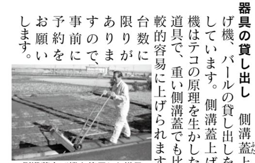
側溝蓋上げ機を使用した様子
