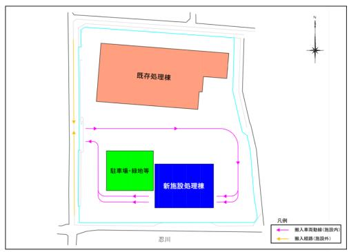
図3 施設内配置・動線計画
