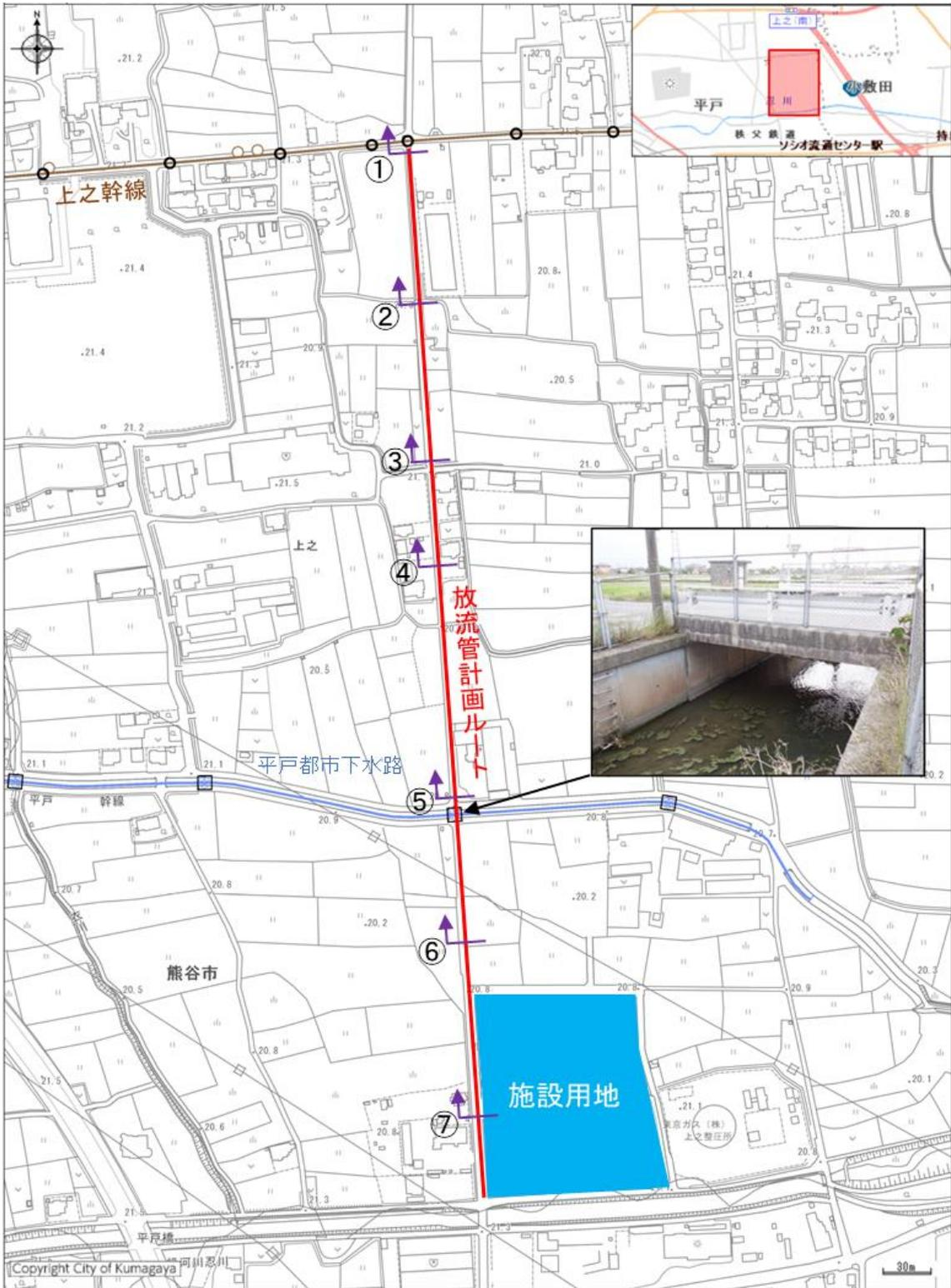
図 8 - 1 放流管接続の概略図（熊谷市下水道台帳を一部編集）
