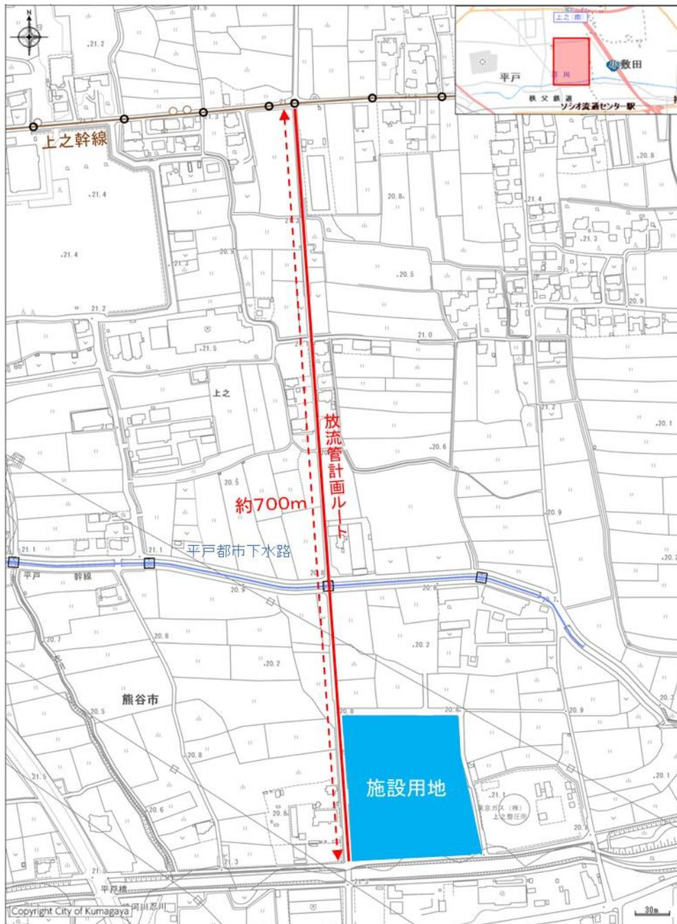
図10-4 放流管接続の概略図(熊谷市下水道台帳を一部編集)
