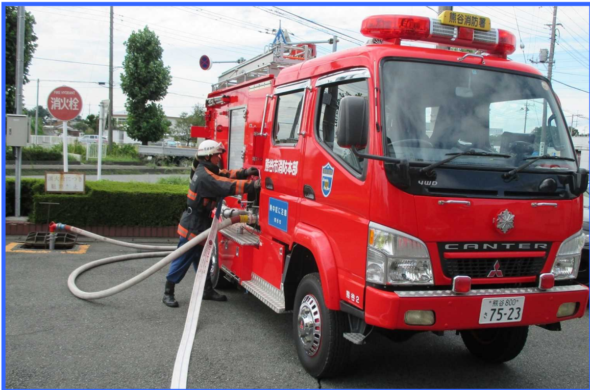
消火栓への部署
