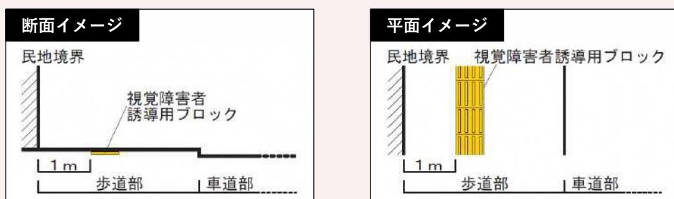
※道路構造令による最低有効幅員2mの歩道では、ほぼ中央に視覚障害者誘導用ブロックを設置することとし、有効幅員3m以上の歩道（自転車歩行者道を含む）では、自転車の通行スペースを車道側にとり、あくまでも民地側の2mについては歩行者を優先するものとする。
